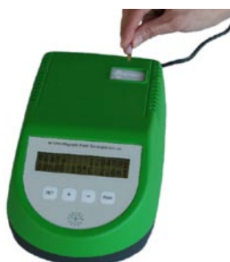
In Vitro Magnetic Field Generator MFG-1000 (magnetfältsgenerator för medicinsk forskning).
